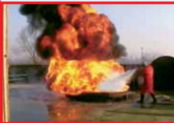
prova di spegnimento classe 233B con polvere da 6 kg
