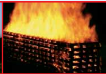
fase di preaccensione di 8 minuti di una prova classe 34 A
